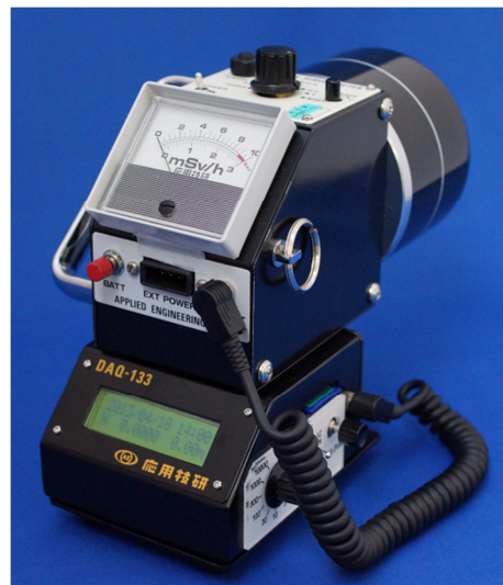
DAQ-133 と電離箱式サーベイメータを組み合わせた様子 (出本器には電離箱式サーベイメータは含まれておりません)
