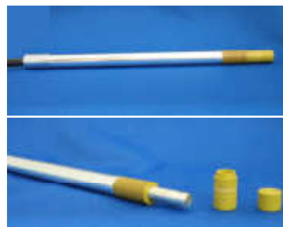
電離箱C-111F 全体；上段 保護カバーを外した状態；下段
