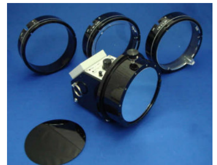
ビルドアップキャップカバー3種類と 本体及びインナーフィルター 上段左から H^*(0.07) 用、 H^*(3) 用、 H^*(10) 用
